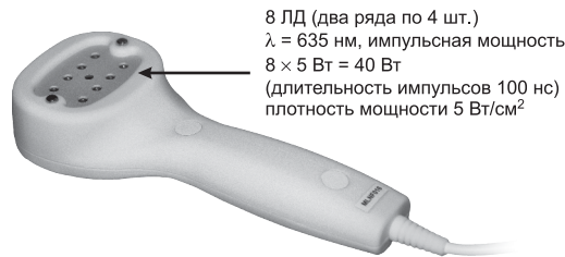
Рис. 10. Матричная лазерная излучающая головка МЛ-635-40
